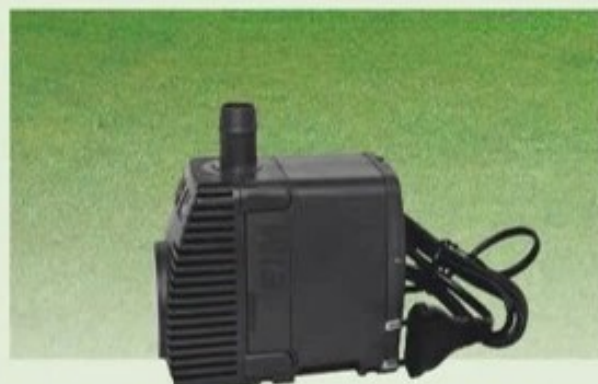
ART. 34 POMPA PER FONTANA "EXTREMA" 2500 L/H PREVALENZA M 3 220 V 35 W
